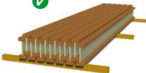
Entreposer les poutres à la verticale dans le sens de la pose finale, c'est à dire en respectant les indications « haut » et « bas ».
