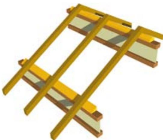
Les charpentes composées de pannes mises en œuvre d'aplomb doivent être complétées par une lisse d'assise profilée selon la pente, ou autre dispositif d'ancrage métallique réglable, pour recevoir le chevronnage ou le panneau de toiture. En aucun cas, la membrure supérieure ne doit être usinée.
