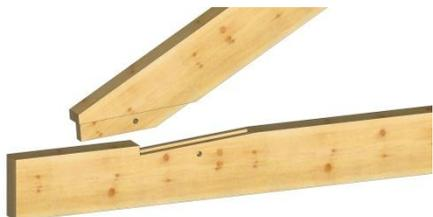
Assemblage par tenon / mortaise
