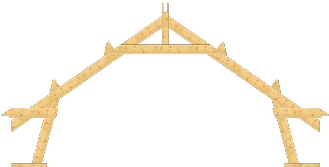
Ferme aménageable sur dalle béton
